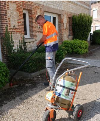
Les mauvaises herbes sont désormais éliminées par un brûleur thermique ou par un désherbage mécanique à l'aide d'une balayeuse-désherbeuse, accompagnée par un aspirateur de voirie.
